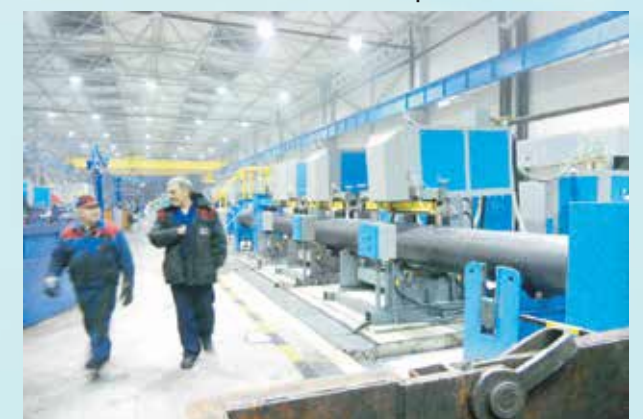
530mm ERW Pipe Mill
