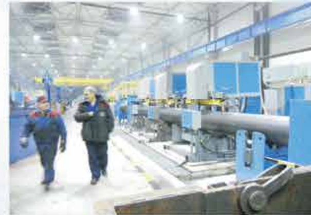
530mm ERW Pipe Mill
