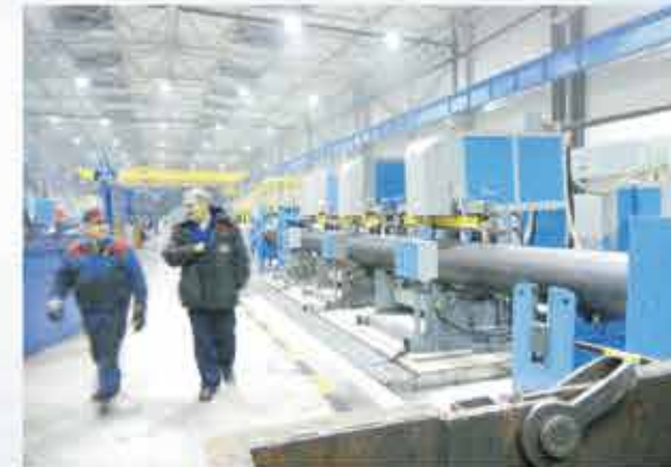
530mm ERW Pipe Mill
